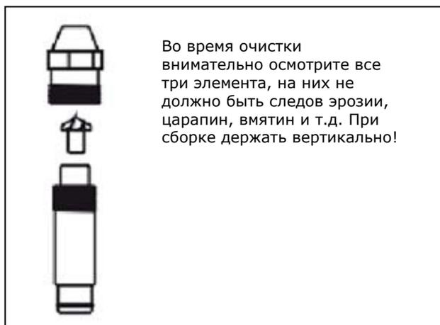
**Рис. 13** Положение форсунки при сборке
